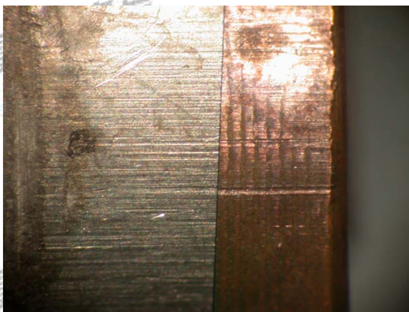
圖 7-7 鉛彈頭（左）及銅彈頭（右）底部表面均具有一致性及相似性之平行條狀紋線
